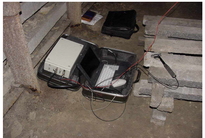
Rys. 3. Przenośny system akwizycji i rejestracji funkcji przejścia – PSAR-FRF, realizacja badań w warunkach rzeczywistych stosowania samodzielnej obudowy kotwiowej.
