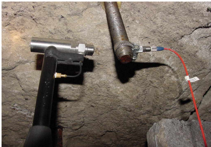
Rys. 4. Wymuszanie drgań młotkiem udarowym, sygnał odpowiedzi mierzony piezoelektrycznym przetwornikiem drgań.
