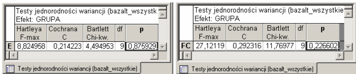
Rys. 7. Wyniki analizy jednorodności wariancji (beton bazaltowy).
