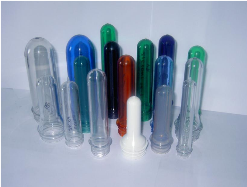
Fot. 2. Przykłady preform produkowanych przez Hanex
