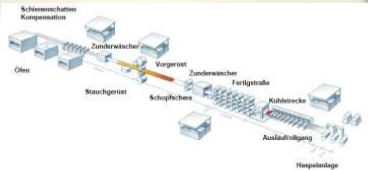
Rysunek 1. Schematyczny układ taśmociągu walcowania na gorąco.
